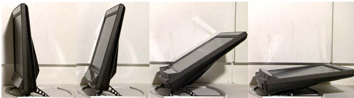
Figur 143-146: Demonstration av fotmekaniken som tillåter mycket stor vinkeländring av eye-trackern
