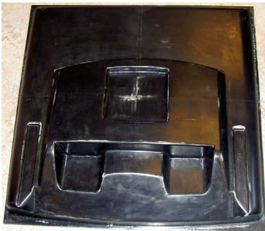
Figur 96, 97: FFF-plugg till bakstycket utsida (vänster) och insida (höger) efter impregnering, sammanlimning, slipning och polering
