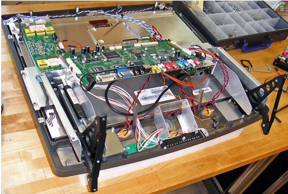
Figur 152: Tobii 2150C innanmäte, nollserieexemplar utan bakstycke, fot och kamera, vid produktion är fotmekanikslutningarna svarta (svarteloxerade eller svartkromaterade) för att inte synas innanför framstycket
