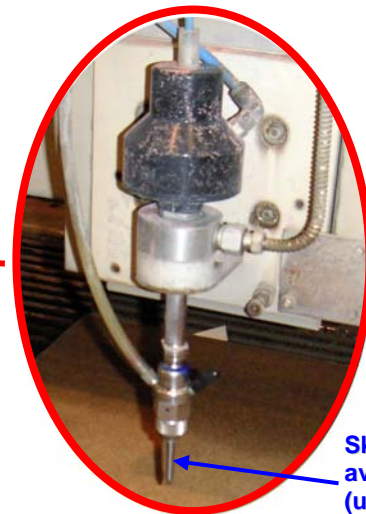
Figur 128: Vattenskärningsmaskin hos PÅ-Vattenskärning, inringad till höger är skärhuvudet där vattnet och abrasivmedlet (slipmedlet) blandas för att sprutas ut ur hårdmetallmunstycket
