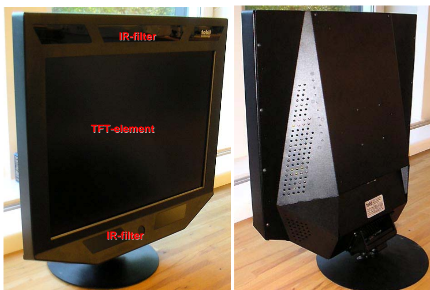
Figur 9, 10: Gamla Tobii 2150 med plåtchassi, Vänster: sedd snett framifrån, Höger: sedd snett bakifrån
