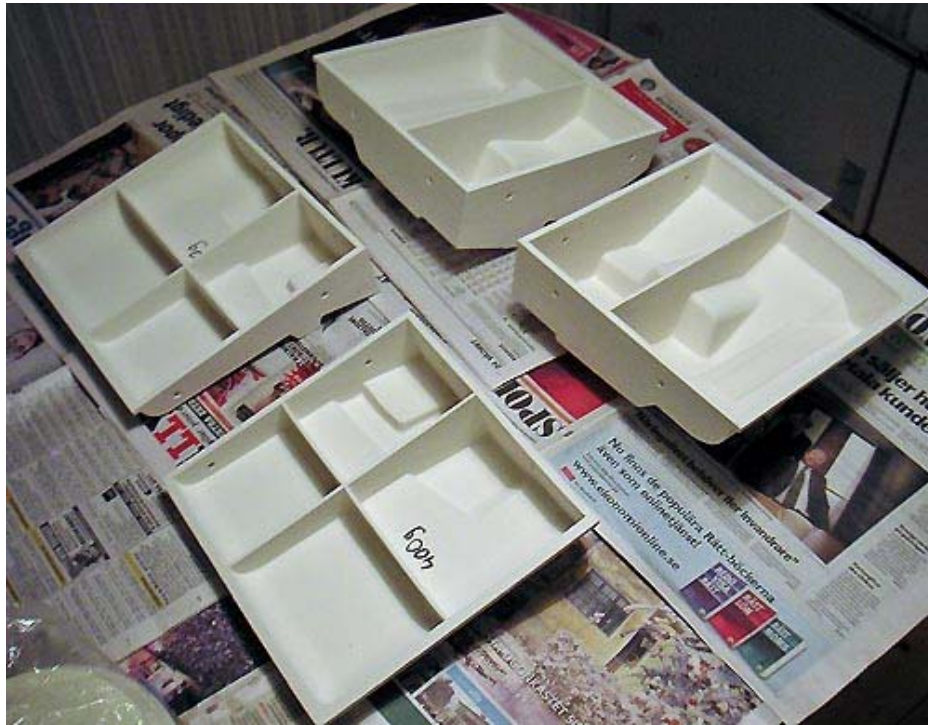
Figur 92: FFF-plugg till bakstycket i de fyra delar som framställdes innan impregnering, sedda från insidan
