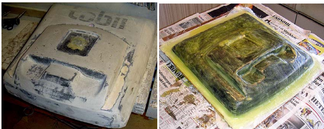
Figur 88, 89: XPS-plugg och form under uppbyggnad Vänster: XPS-plugg spacklad med epoxibaserat mikrobalongspackel, grovt slipad Höger: Glasfiber-epoxiformen laminerad över XPS-pluggen. Masonitplattan som limmats mot pluggen utnyttjas som mothåll då den negativa formen avlägsnas, och vidare då laminerade prototypbakstycken avlägsnas från formen.
