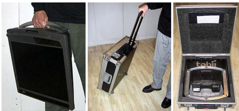
Figur 155-157: Demonstration av eye-trackerns transportbarhet: Vänster: Eye-trackern kan bäras med foten som handtag vid kortare transporter Mitten: Vid längre transporter utnyttjas den hjulförsedda specialframtagna väskan (flight-case) Höger: Väskan visas öppen, väskan inrymmer eye-trackern och alla dess tillbehör i olika fack
