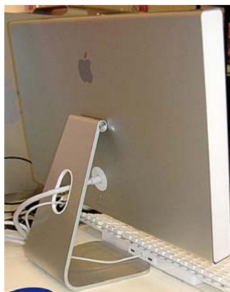
Figur 30: Monitorfot på en Macintosh med ren design, böjd aluminiumprofil infäst i tyngdpunktcentrum, dock ej i VESA-fästet (som saknas på denna skärm/dator)
