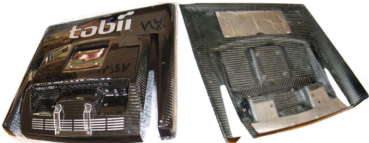
Figur 124, 125: Utsida och insida av lackat bakstycke med metallnät och kabelavlastare monterade
