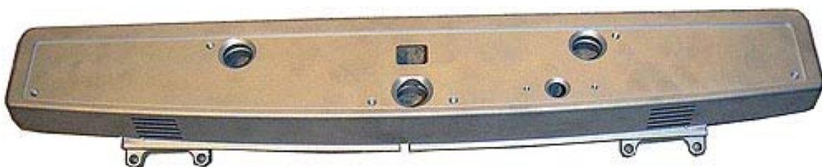
Figur 134. Nederdelen till framstycket, sedd utifrån, blästrat och olackerat. Denna del är 5-axligt fräst och skruvas mot framstyckets ram innan pulverlackering
