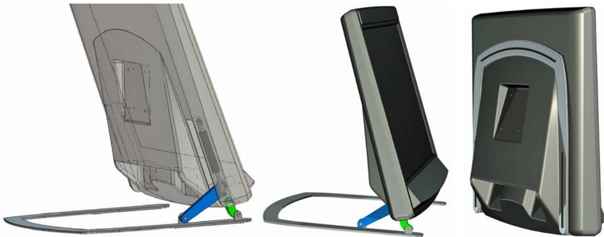
Figur 33-35: Exempel på CAD-modeller under utvecklingsarbetet med fot- och fotmekanik
