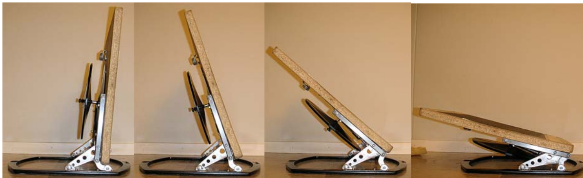
Figur 36-39: Demonstration av olika lutningsinställningar för eye-trackern på en prototyp där eye-trackern har ersatts med en spånplatta och en vikt. Från vertikalt, något framåtlutande läge längst till vänster, till nästan horisontellt läge längst till höger
