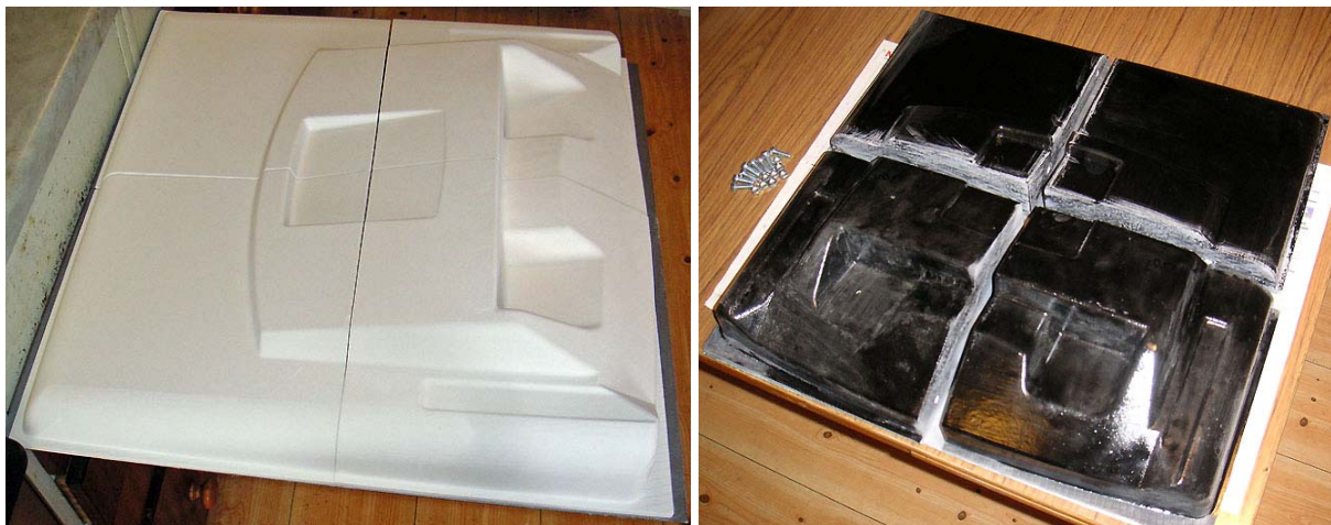
Figur 93, 94: FFF-plugg till bakstycket, innan impregnering (vänster) och efter impregnering inför sammanskruvning och limning (höger)
