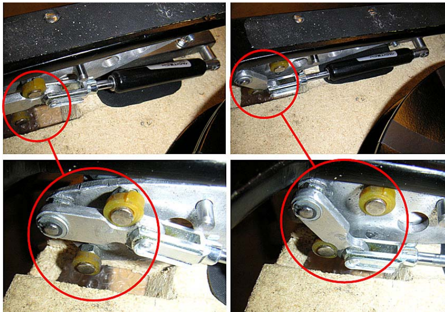
Figur 42-45: Demonstration av fotmekanikens två lägen på en prototyp där länkkopplingen till gasfjädern ("snäppleden") är inringad och förstord.
