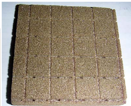
Figur 58, 59: Exempel på transportsikt för vakuuminjicering Vänster: "Sommarväv", glest vävd av fiskelineliknande plasttrådar Höger: Kärnmaterial (Divinycell) med hartsledande kanaler
