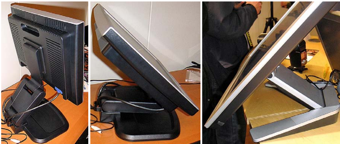
Figur 27, 28, 29: Exempel på flexibla monitorfötter: Vänster och mitten: HP, Höger: Okänt märke
