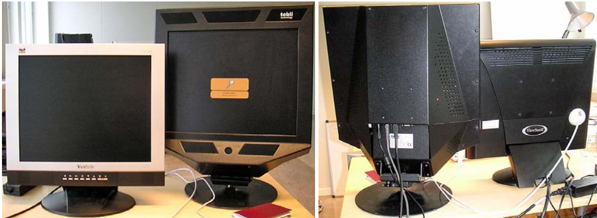
Figur 21, 22: Exempel på monitorfötter som fäster mot nederkanten, den större är en Tobii 1750 eye-tracker, den mindre en ViewSonic 17-tumsmonitor. Monitorfötterna medger ingen höjdregering och har en starkt begränsad möjlighet att ändra lutningen
