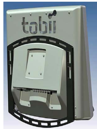
Figur 77: CAD-modell som visar exempel på hur en vattenskuren aluminiumfot (svartlackerad) skulle kunna se ut i uppfällt läge, hål har skurits ut i foten för att ge låg vikt i förhållande till böjstyvheten
