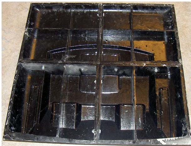
Figur 96, 97: FFF-plugg till bakstycket utsida (vänster) och insida (höger) efter impregnering, sammanlimning, slipning och polering
