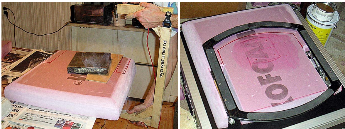
Figur 86, 87: XPS-plugg för prototypbakstycke under uppbyggnad Vänster: Värmetrådsskärning Höger: Pluggen testas med prototypfot och fotmekanik
