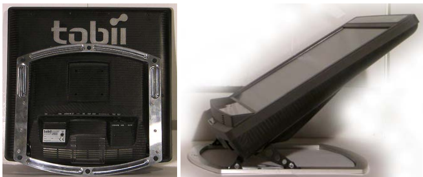
Figur 153, 154. Demonstration av foten i olika lägen Vänster: Foten uppfälld, Höger Foten utfälld, eye-trackern inställd i ett relativt horisontellt läge anpassad för att presentera en virtuell tidning
