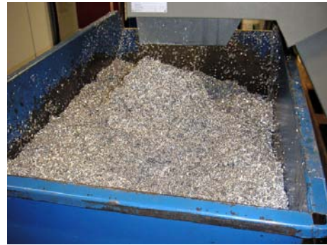
Figur 73. Aluminiumsspånor efter CNC-fräsning hos LG produktion, spillet återvinns och smälts om till ny aluminium
