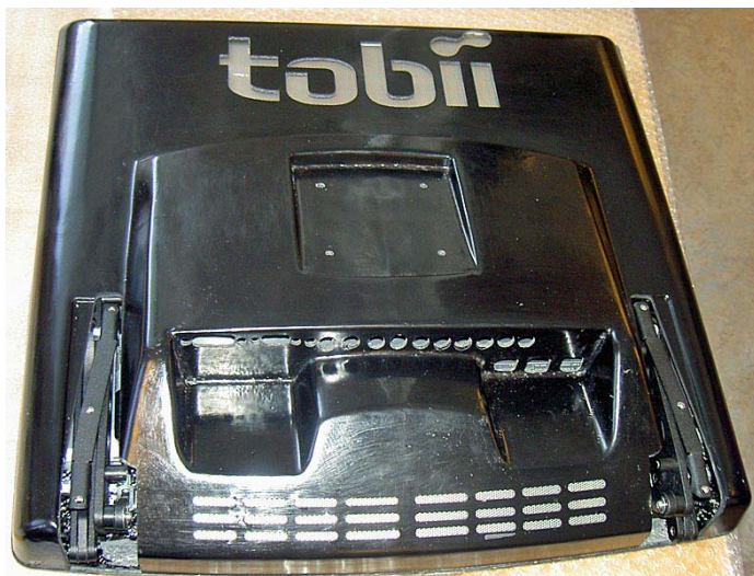
Figur 101, 102: Prototypbakstycke (med svart gelcoat), vattenskuren med nät monterat
