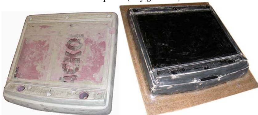
Figur 103, 104: XPS-plugg av framstycket under uppbyggnad
