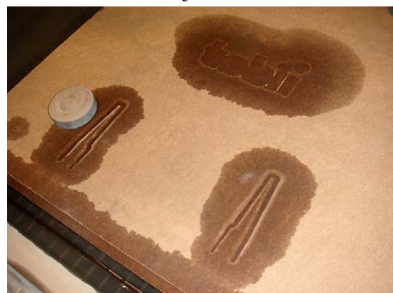
Figur 129: Masonitskiva som använts som underlag vid vattenskärningen av bakstycket, vid planet för logotypen och uttag för fotmekaniken
