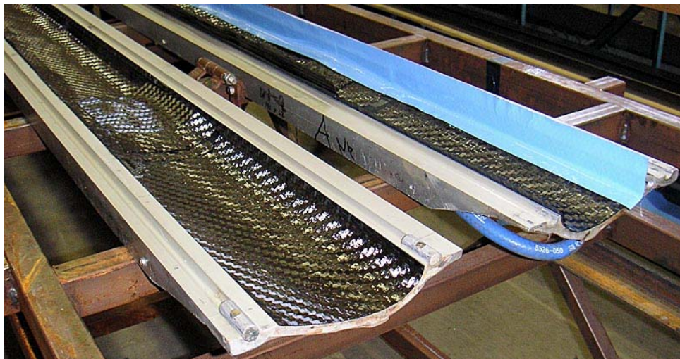
Figur 62: Uppläggning av pre-preg (kolfiberväv impregnerad med värmehärdande epoxi) till en båtmast hos Marström Composite
