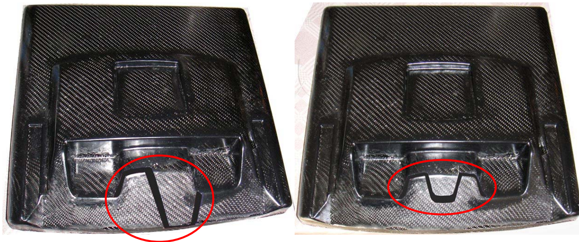
Figur 83, 84: Två alternativ (inringade) för kabelavlastare direkt i bakstycket genom vattenskurna spår
