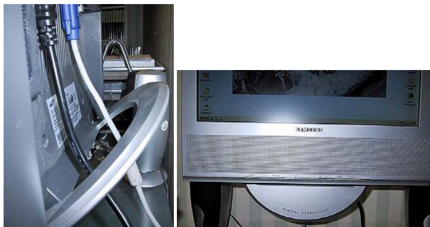
Figur 23, 24: Exempel på monitor (Samsung Syncmaster 710 mp) med fot fäst i nederkanten som kan fällas in (på bilderna är den upphängd i VESA-fästet), foten går endast användas i lutningar nära vertikalt läge
