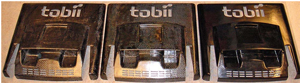
Figur 100: Tre prototypbakstycken efter vattenskärning av ventillationshål och urtagen till fotmekaniken
