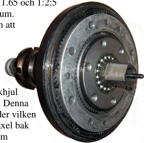
Figur 9-49: Schlumpf High Speed Drive, vevpartiplanetväxel med 1:2,5ggr uppväxling, öppen utan kedjedrev där mekanismen syns
