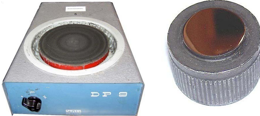
Figur 21.10-5,a,b, Vänster polermaskinen, Höger: Polerat materialprov
