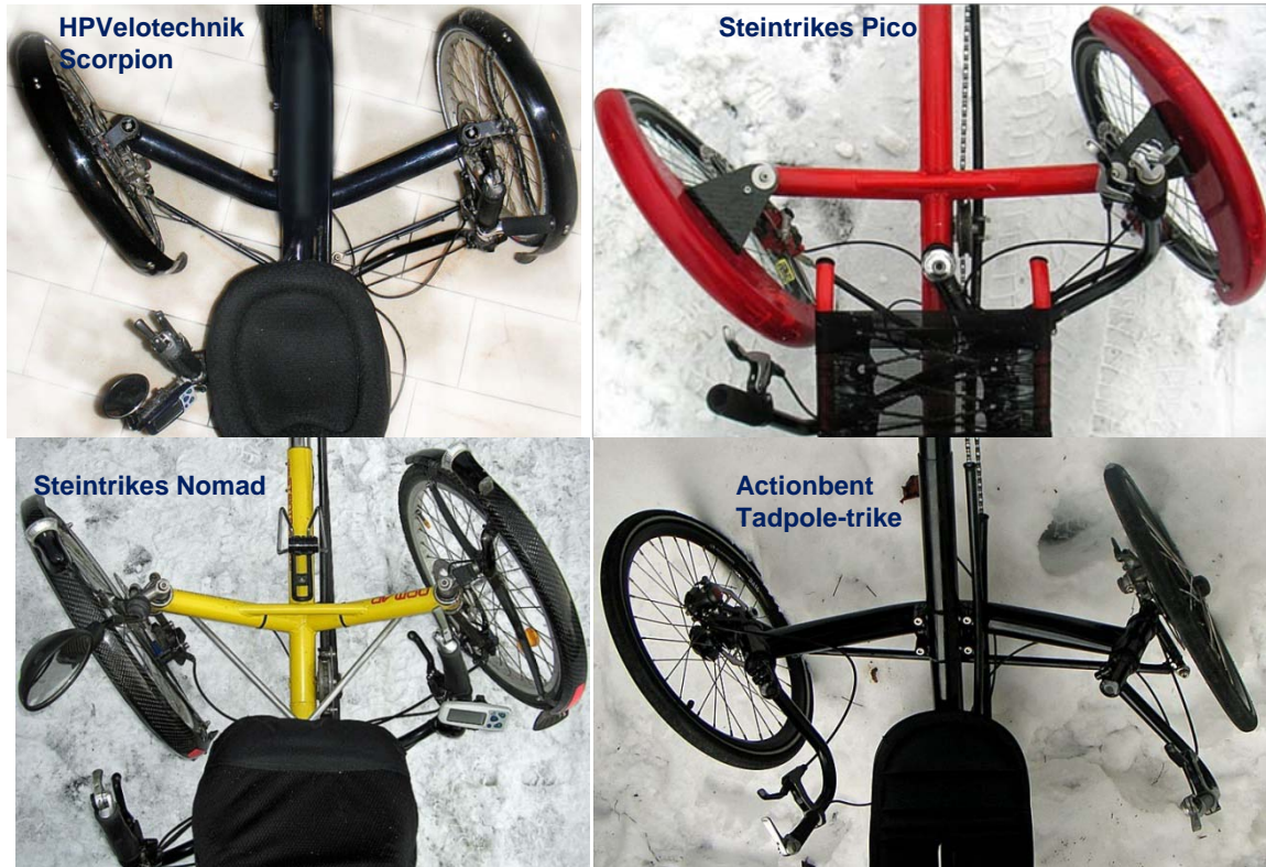
Figur 10-1,a-d: Styrningen på testtrikarna vid max styrutslag åt vänster
