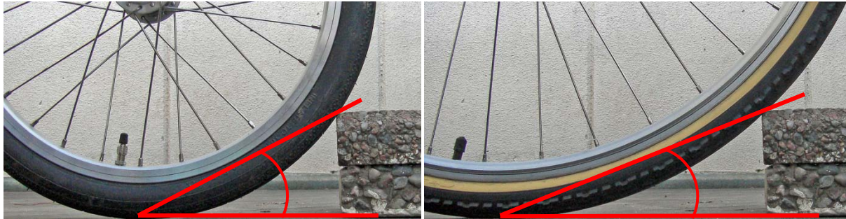
Figur 9-26,a,b: Skillnaden mellan anfallsvinkeln för ett litet respektive stort hjul som går över samma hinder. Vänster: 16" hjul (ISO 349mm), Höger: 28" (ISO 622 mm)
