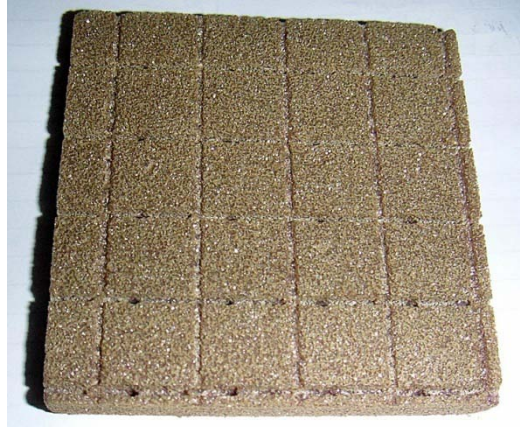
Figur 12-7,a,b: Exempel på transportskikt för vakuuminjicering Vänster: "Sommarväv", glest vävd av fiskelineliknande plasttrådar Höger: Kärnmaterial (Divinycell) med hartsledande kanaler
