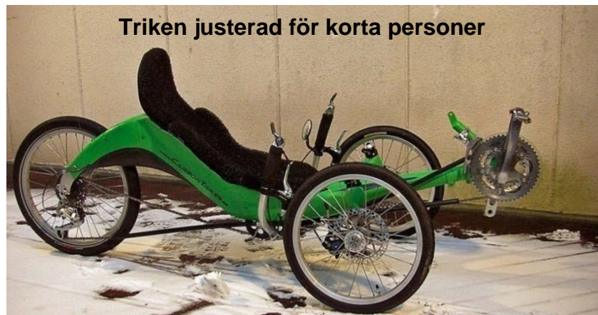
Figur 9-80: Trikeprototypen justerad för korta personer (ca 160 cm)
