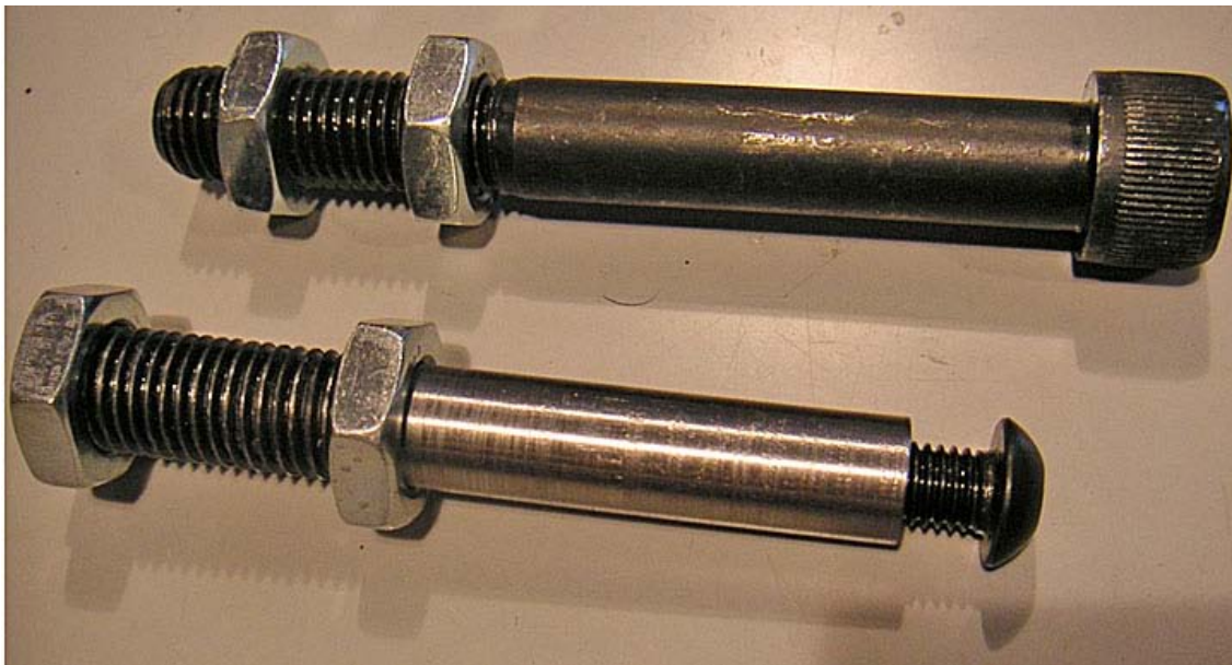
Figur 21.10-1. Ovan: M16-skruv Nedan: Framhjulsaxel där skruven nersvarvad till 15mm med i gängad ändskruv. Den del som har analyserats är änstumpen vid skruvhuvudet som blivit över då axeln har svarvats.
