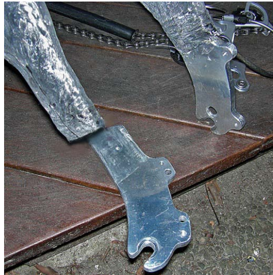
Figur 9-72: Vänster drop-out (bakhjulsupphängning) avtagen från trikeprototypen innan ramen lackats
