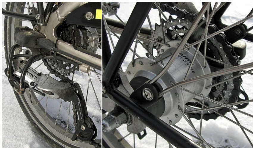
Figur 9-48, a,b: SRAM DualDrive (kombinationsväxel, kedjeväxel+navväxel) monterad i ett 20"-hjul
