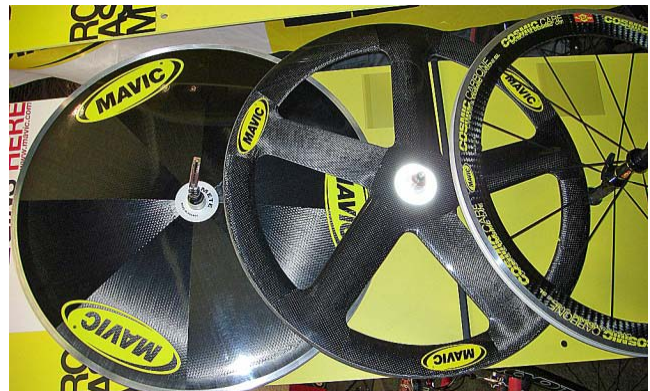
Figur 9-27: Exempel på aerodynamiska specialhjul som endast finns i större format, främst 28" (ISO 622mm)
