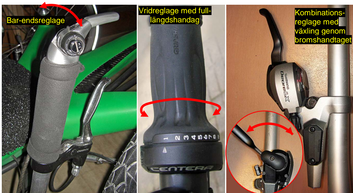
Figur 9-52,a-c: Växelreglage anpassade för undersätesstyrningar, pilarna visar rörelsen vid växling
