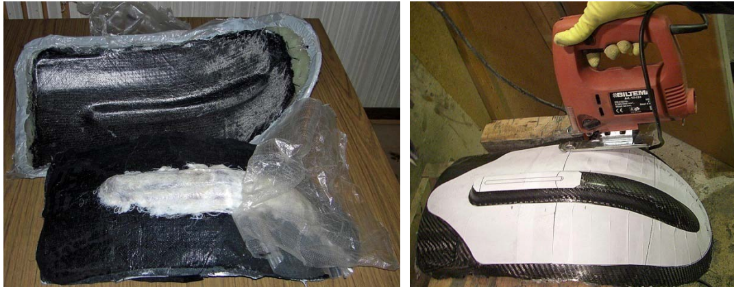
Figur 12-5,a,b: Laminering med vakuumbag, steg 8 och 9
