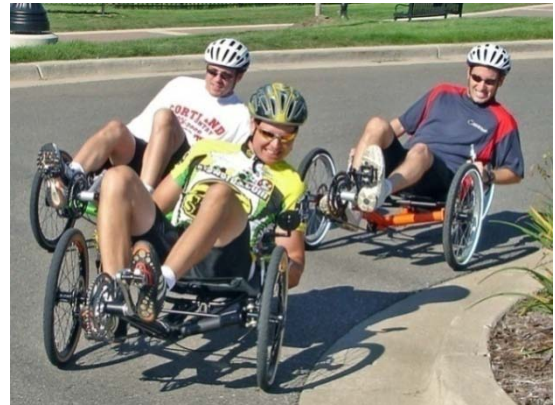
Figur 9-78: Forsering av kurva under cykeltävling med tadpole-trikar, observera hur cyklisterna lutar innåt i kurvan för att kunna forsera den i hög fart utan att riskera att triken går upp på två. Källa: Terratrikes
