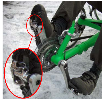
Figur 9-61: Cyklar trikeprototypen med SPD-pedaler (dubbelsidig) och SPD-skor
