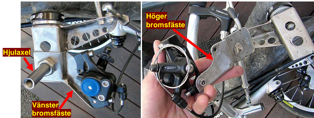
Figur 14-5,a,b: Vid hjulbyte flyttas bromsfästet för att hamna rätt i förhållande till bromsskivan
