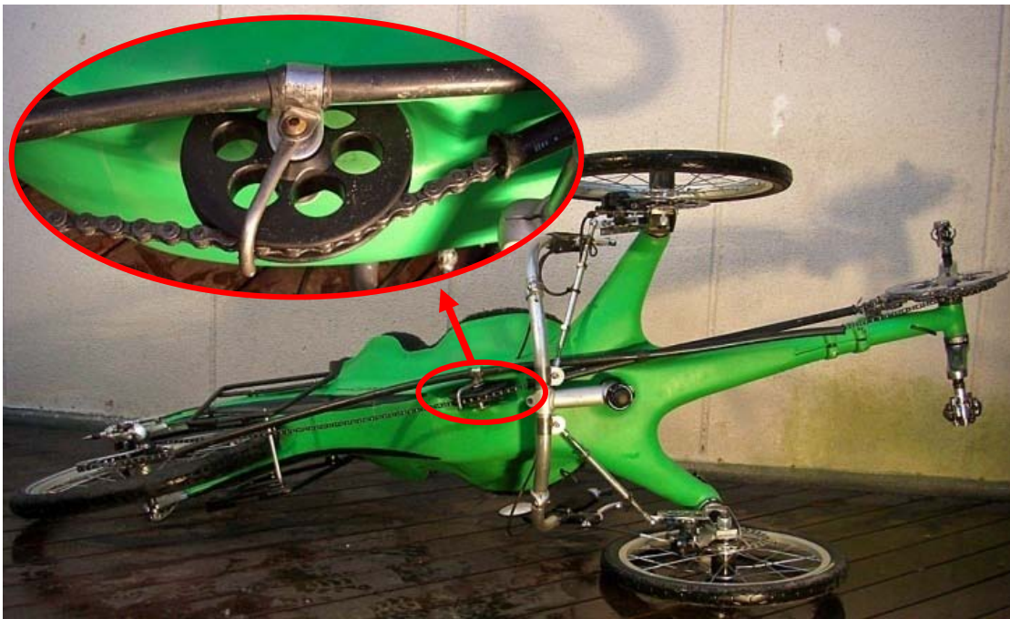
Figur 9-45: Undersidan av trikeprototypen där kedjan som går under hela ramen syns, kedjehjulet som styr kedjan under ramen är inringad (sedd snett underifrån)
