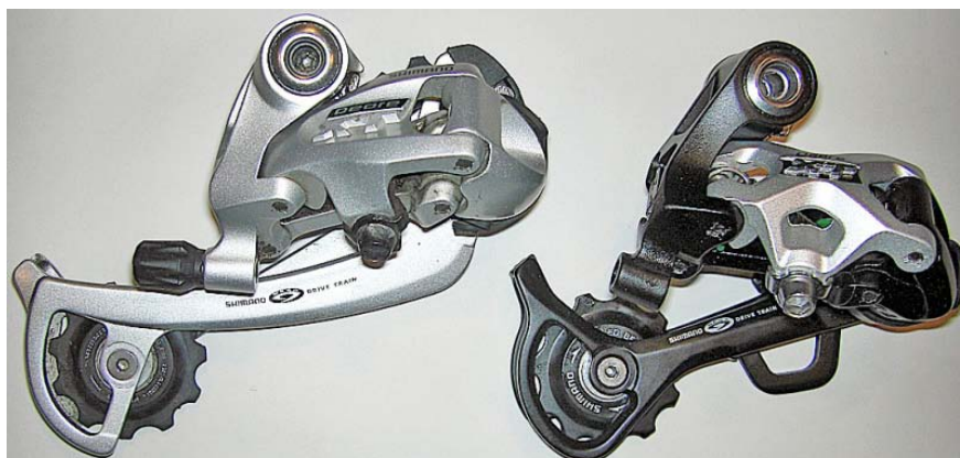
Figur 9-29: MTB-bakväxel (Shimano XT) i två olika utföranden, vänster extralång arm (SGS), höger: lång arm (SG)
