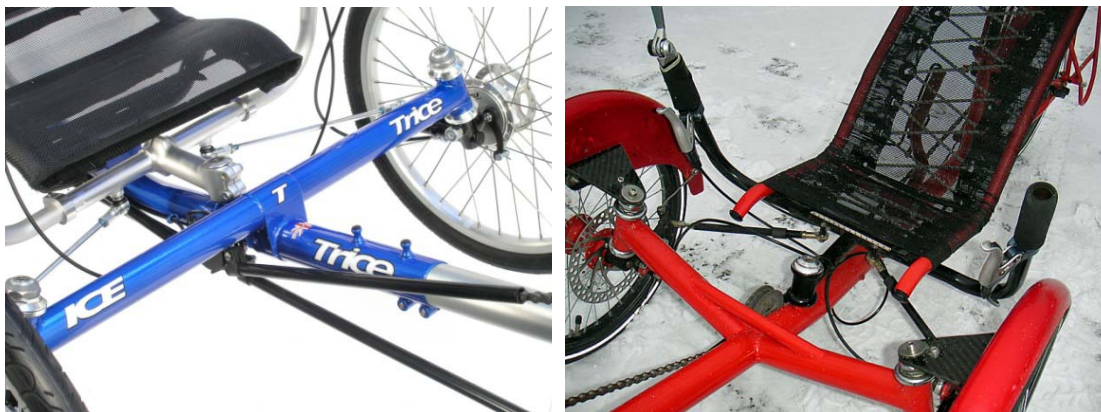
Figur 9-15,a,b: Konventionell styrning på trikar: Vänster: Detaljbild av styrning på ICE T, Källa: ICE Höger: Detaljbild av styrning på Steintrike Pico
