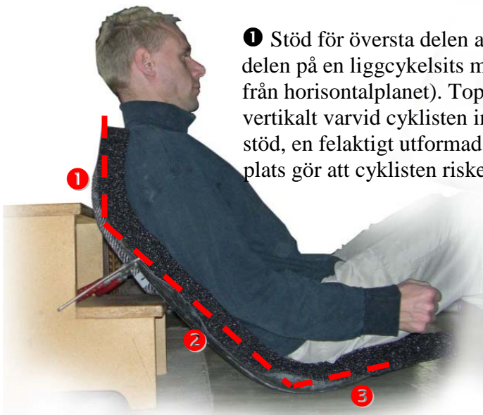
Figur 9-40: Stödytor för en liggcykelsits visas på en testuppställning under utveckling av CarbonTrikes sits
