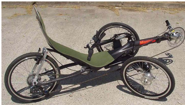
Figur 18-12,a,b: Velokraft trikeprototyper, Vänster: vikt ca 16kg, 2003-07-04
