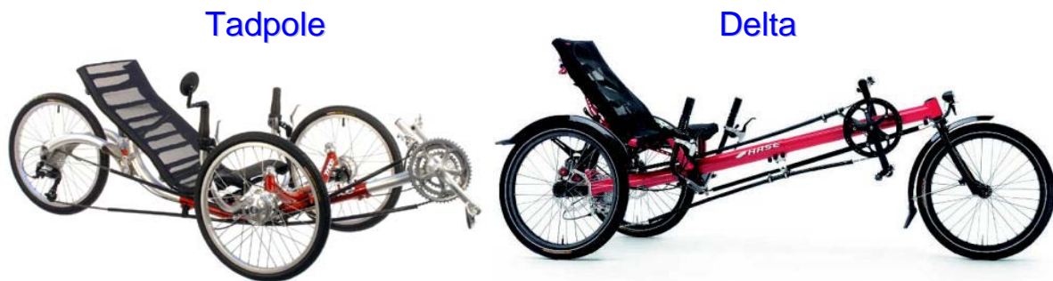
Figur 7-2,a,b, Vänster: Typisk tadpole-trike, ICE S, Höger: Typiskt deltatrike, Hase Kettweiser Källor: ICE, Hase Spezialrade
