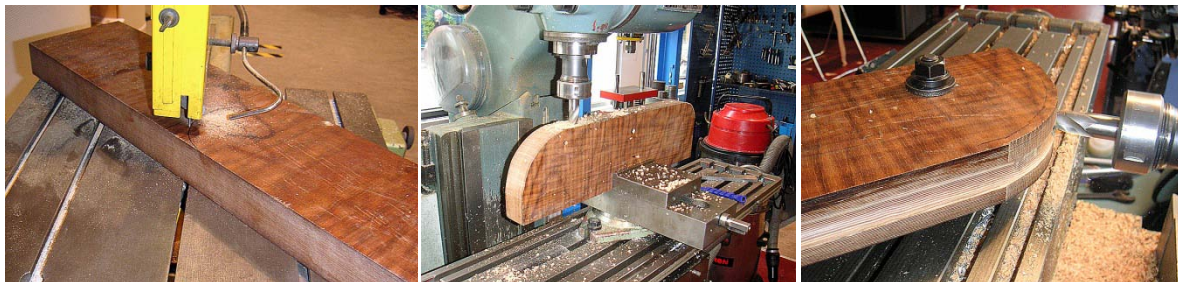
Figur 14-9,a-c: Tillverkning av rörbockningsutrustning: Vänster: Utsågning med bandsåg, Mitt: Fräsning av långsidan, Höger: Fräsning av bockradien
