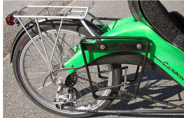
Figur 9-66: Trikeprototypen med båda pakethållarna monterade
