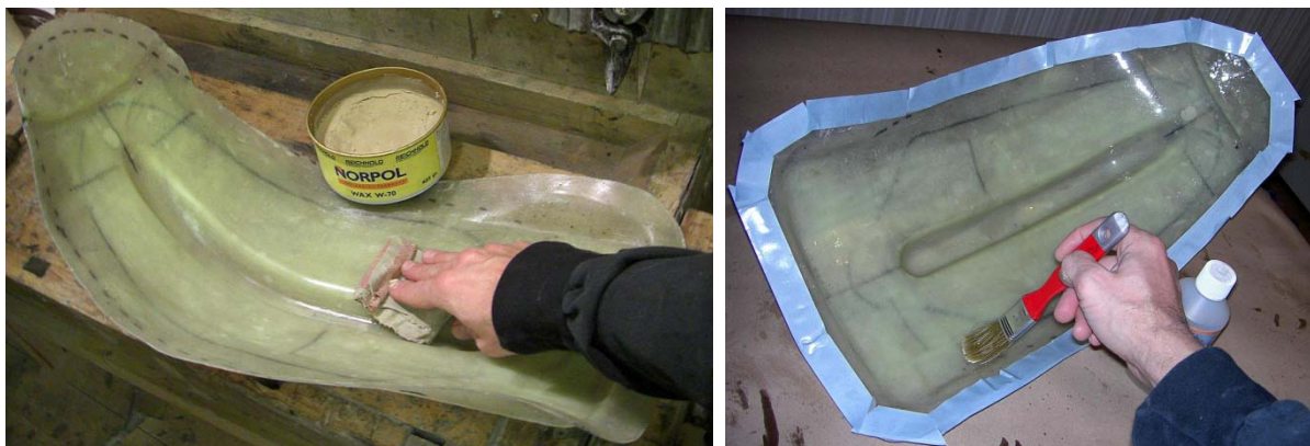
Figur 12-1,a,b: Laminering med vakuumbag, steg 1
