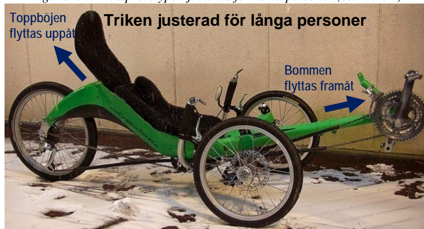
Figur 9-81: Trikeprototypen justerad för långa personer (ca 190 cm)
