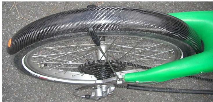
Figur 9-65: Bakre stänkskärm i kolfiberkomposit
