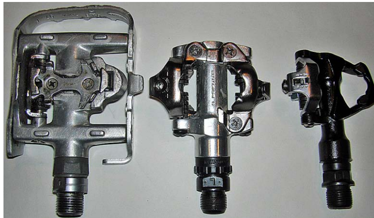
Figur 9-62: SPD-pedaler: vänster: dubbelfunktion, mitt: dubbelsidig, höger: enkelsidig
