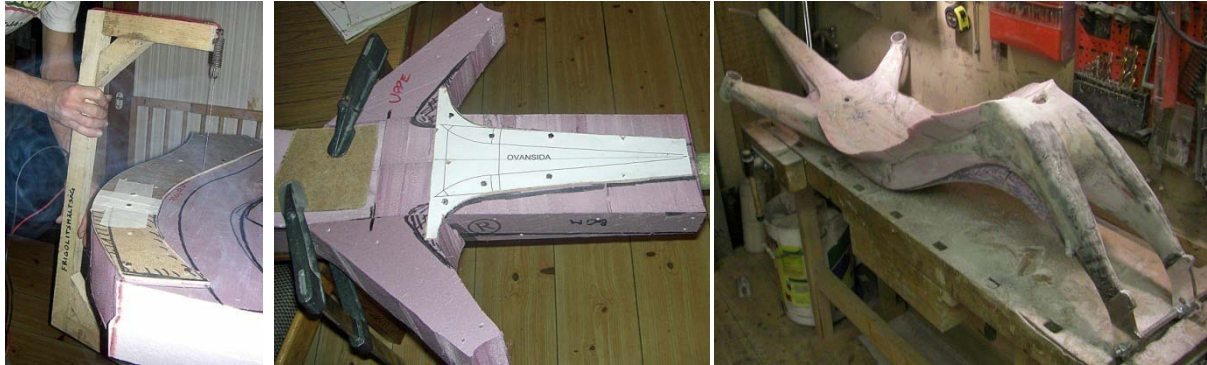
Figur 14-2,a-c: Tillverkning av kärnan till ramen: Vänster: Värmetrådsskärning av XPS till ramens kärna Mitt: Uttriggare och del mot bom innan värmetrådsskärning Höger: Skumplastkärnan innan vakuumbagningen
