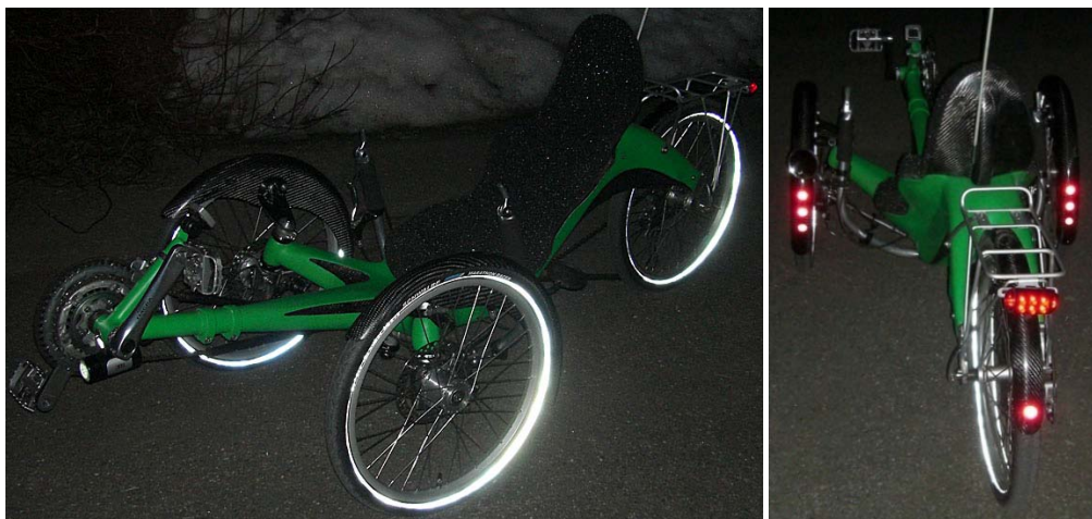
Figur 9-69, a, b: Trikeprototypen fotad i mörker med blixtn för att visa hur reflexerna syns, däcken har vita reflexidor, bak på stänkskärmarna sitter röda reflexer, framtill sitter en vit, belysningen fram och bak är även på
