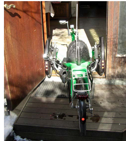
Figur 9-76: Med en totalbredd under 75 cm kommer triken genom de flesta dörröppningar (trikeprototypen är 71cm)
