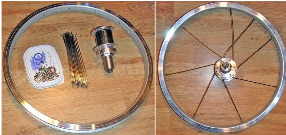
Figur 21-1: Ekring av 16"-hjulet med lättviktsnavet
