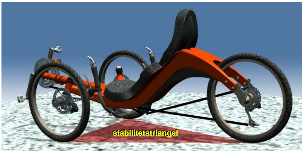
Figur 9-75: CAD-bild där stabilitetstriangeln som bildas under hjulen visas
