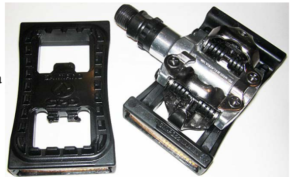
Figur 9-63: Plastkloss som konverterar dubbelsidiga SPD-pedaler till dubbelfunktionspedaler
