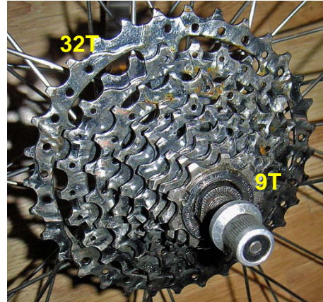
Figur 9-46: Specialkomponerad Shimano Capreo-kasset, 9-32T
