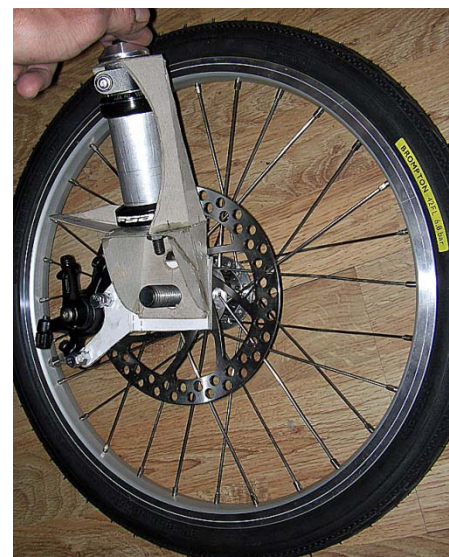
Figur 9-33: Modellförsök i kartong av hjulupphängning och bromsfäste
