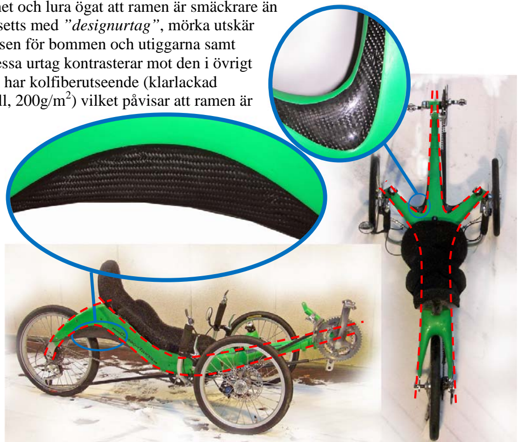
Figur 11-1: Ramens övergripande svepande linjer (streckade markeringar) och delförstoringar med ” designurtag ” – mörka ytor med kolfiberutseende som gör att trikens ram ser smäckrare ut än den egentligen är och samtidigt indikerar på att trikens ram är gjord av kolfiber
