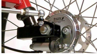
Figur 9-58: Hydraulisk trumbroms på tadpole-trike, Källa: Antrotech
