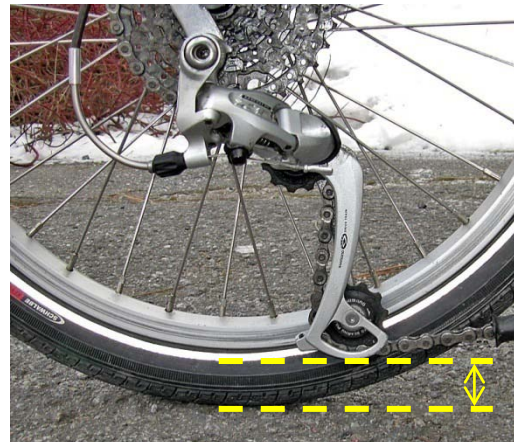
Figur 9-28: Bakväxel med extralång arm (SGS) monterad på en cykel med 20"-hjul, vid maximalt utsträckt läge är distansen till marken liten
