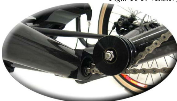
Figur 18-4,a,b: Kedjeföring genom ena ramröret, vänster: inloppet vid bommen, Höger: Utloppet vid bakhjulet
