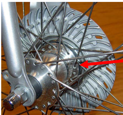
Figur 9-59,a,b: Vänster: Rullbroms med kylning, Höger: Detaljbild av rullbromsen och dess funktion
