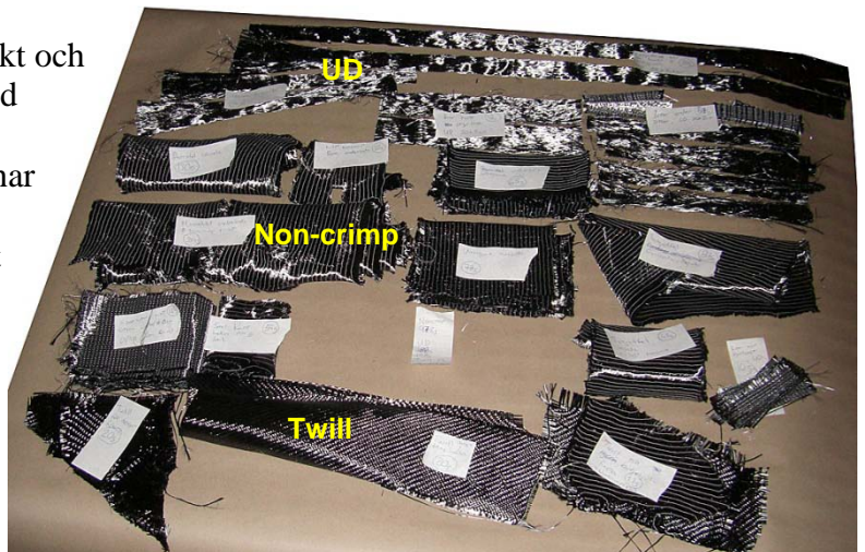
Figur 12-17: Alla kolfiberbitar ramen är uppbyggd av urklippta och sorterade inför lamineringen av ramen
