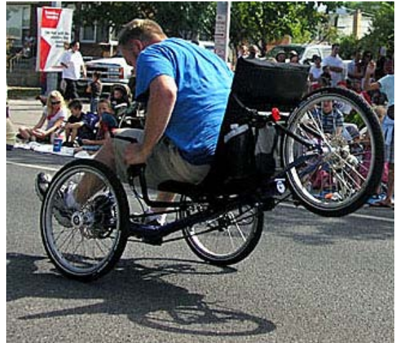
Figur 9-74,a,b: Demonstrationer av kraftig inbromsning med tadpole-trikar kan leda till att bakhjulet lyfter, Höger, källa: UtahTrike
