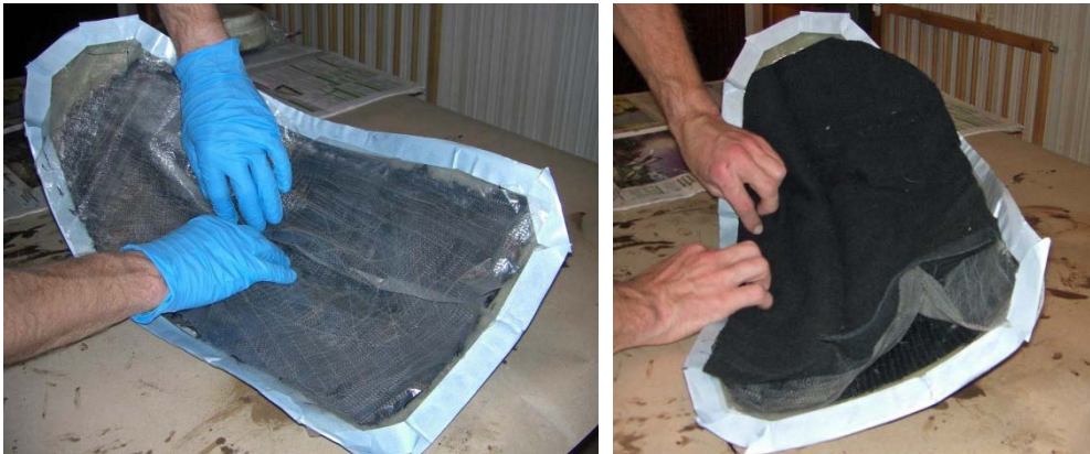
Figur 12-3,a,b: Laminering med vakuumbag, steg 4 och 5
