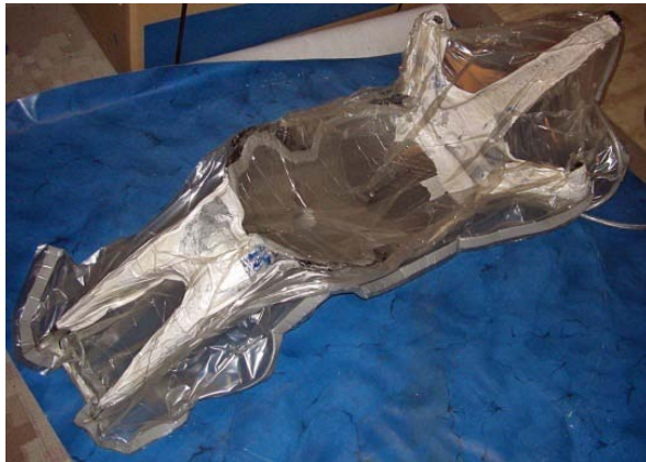
Figur 14-4,a,b: Vakuumbaging och värmehärdning av prototypen:
