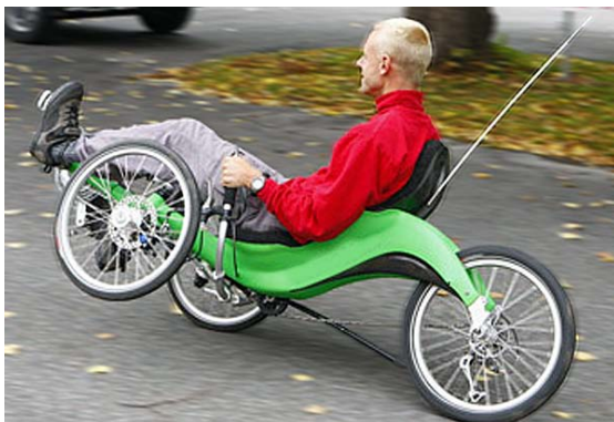
Figur 9-77: Demonstration av hur trikeprototypen kan gå upp på två hjul i en kraftig sväng om inte cyklisten förflyttar tyngdpunkten
