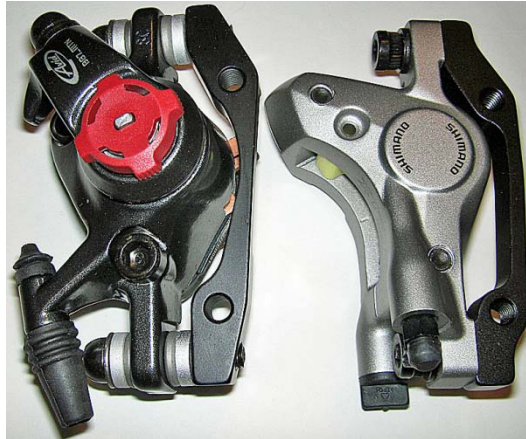
Figur 9-56: Skivbromsar, vänster: mekanisk (Avid BB7), höger: Hydraulisk (Shimano LX)
