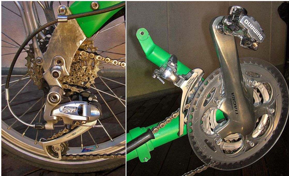
Figur 9-54,a,b: Detaljbilder av växelsystemet vänster: bakväxel och kassett (9-32T), höger: framväxel och vevparti
