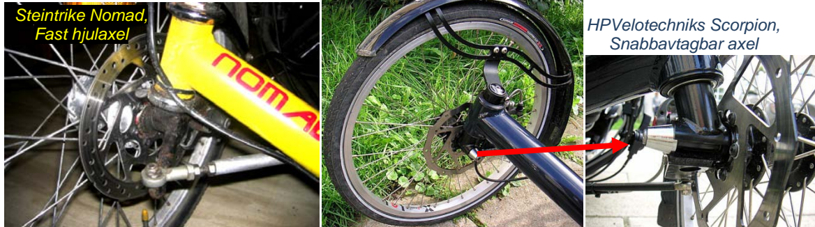
Figur 9-32,a-c: Exempel på hjulaxlar på framhjulsupphängningar
