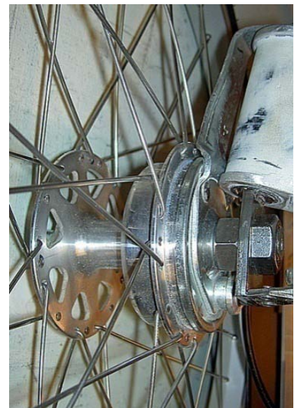
Figur 9-57: Trumbroms på tadpole-trike tillsammans med modifierat nav (för större axel)
