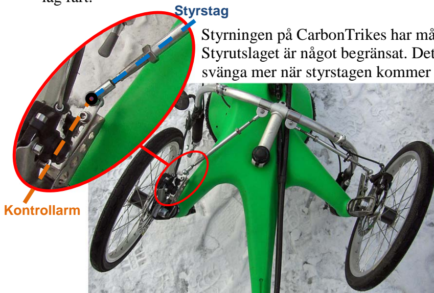
Figur 9-23: Styrningen på prototypen sedd underifrån vid max styrutslag. Förstorad visar styrstaget och staget från hjulupphängningen (de är markerade med streckade linjer) som nästan är i linje med varandra.
