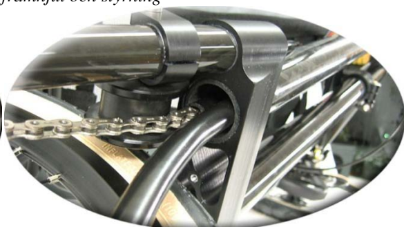
Figur 18-4,a,b: Kedjeföring genom ena ramröret, vänster: inloppet vid bommen, Höger: Utloppet vid bakhjulet
