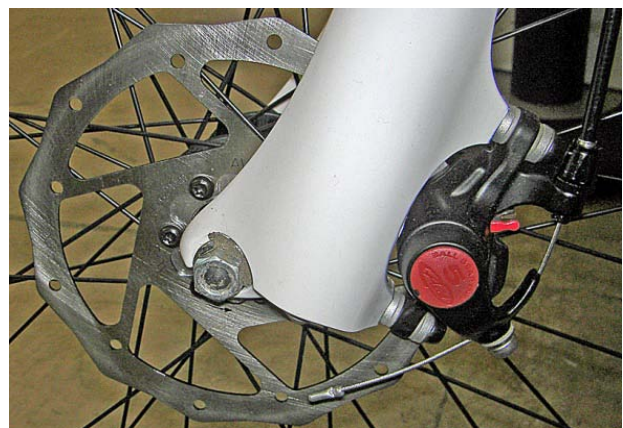
Figur 9-55: Mekanisk skivbroms på MTB-framgaffel
