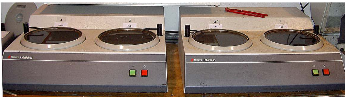
Figur 21.10-4. De fyra våtslipskivorna försedda med sandpapper (från höger till vänster 180, 320, 500, 1000)
