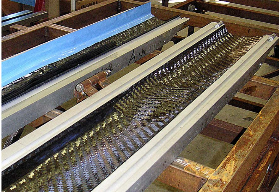
Figur 12-10: Uppläggning av pre-preg till en båtmast hos Marström Composite
