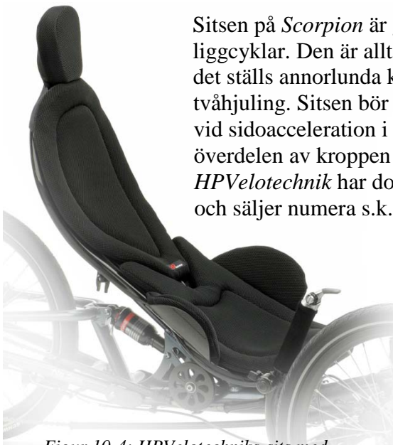
Figur 10-4: HPVelotechniks -sits med tillbehör, seat-wings och nackstöd Källa: HPVelotechnik
