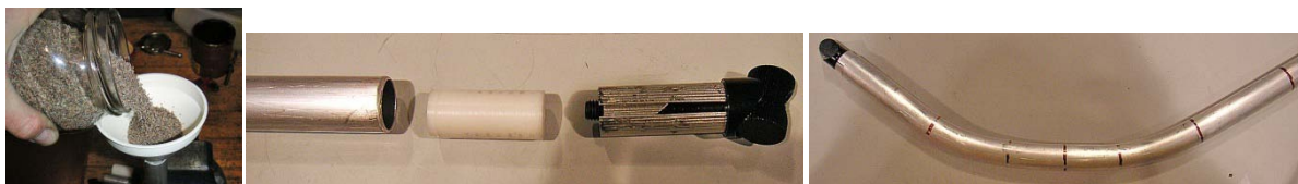
Figur 14-10,a-c: Bockning av rör till styrningen: Vänster: Påfyllning av sand i röret Mitt: Tilltäppning av ändarna med expanderbult för att hålla sanden på plats Höger: Mittsektionen av styret bockad
