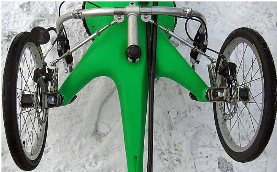
Figur 9-21: Prototypens styrning sedd underifrån
