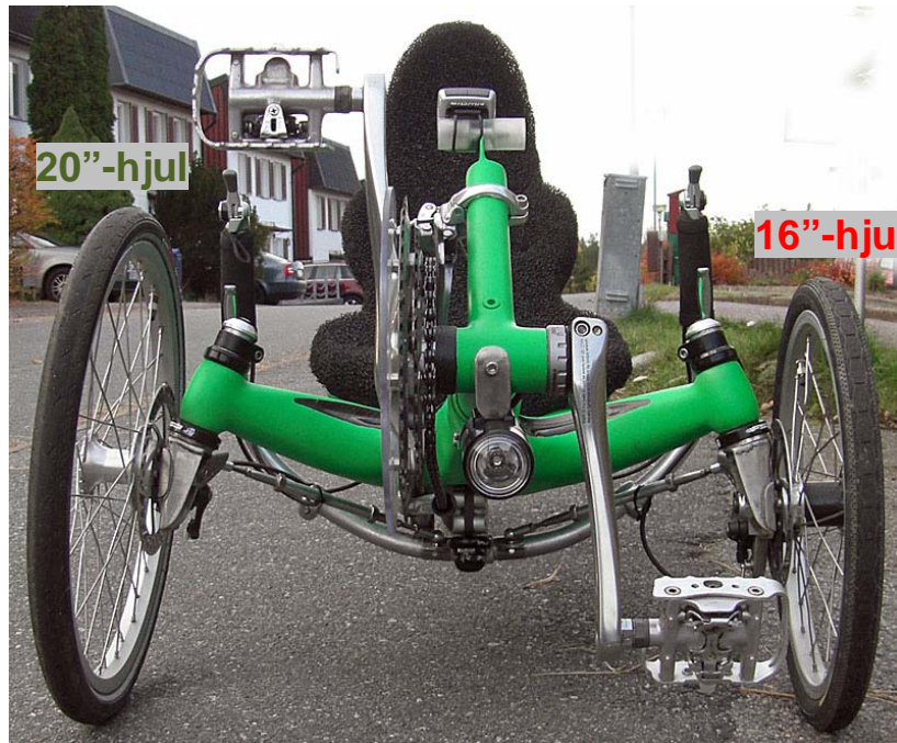
Figur 9-35: CarbonTrikes prototyp sedd framifrån, med stort hjul (20") monterat på höger hjulupphängning och litet hjul (16") monterat på vänster hjulupphängning. Observera att varken höjden eller styrgeometrin ändras
