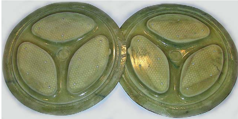
Figur 12-13: Exempel på dubbelsidig slutna form, för framställning av ihåliga 3-ekrade komposithjul
