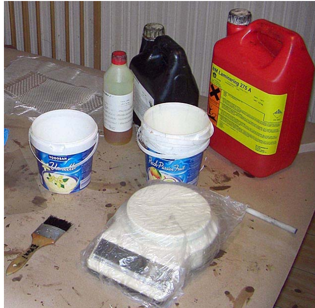
Material vid laminering → epoxi, fiber, kärl, våg, pensel
